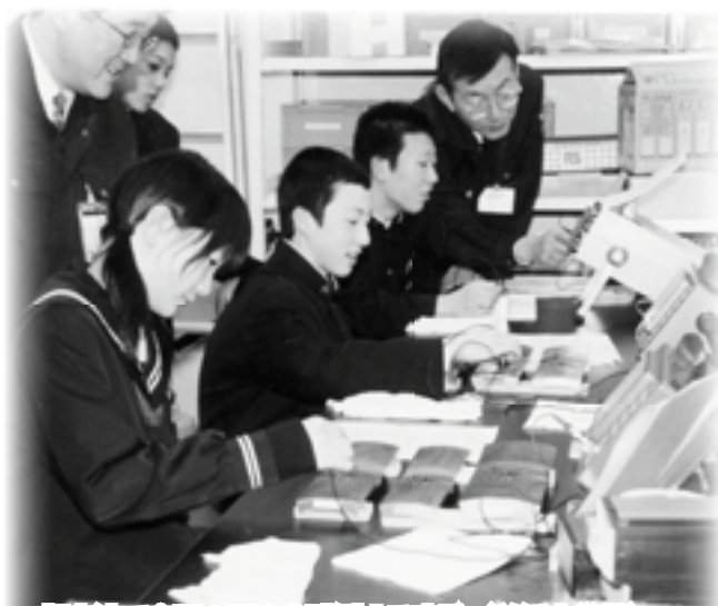
超音波で金属の厚さを計測する実験（美浜中学校） ～原子力安全システム研究所(佐田)にて～
