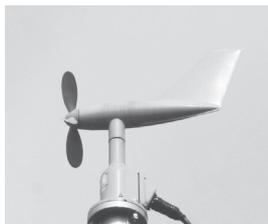
↑左写真中央にある高さ約10mのポールの先端に取り付けられている風速計。風速だけでなく風向も観測する。
