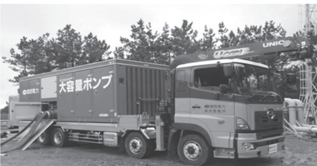
↑海水ポンプの代替として配備した「大容量海水ポンプ車」(通常は海拔32mの高台に配備)
