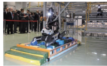
↑障害物を乗り越える遠隔操作ロボット
