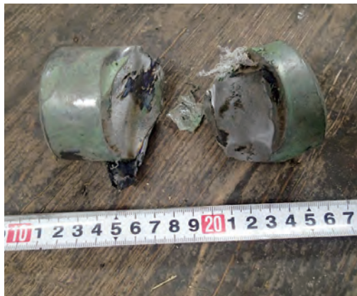
↑混入されていた金属製の異物
