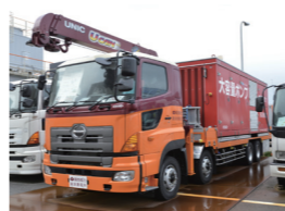
↑大容量ポンプ車
