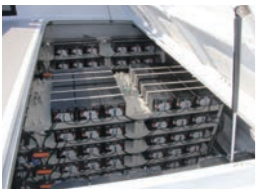
←船体後部に搭載されている リチウムイオン2次電池 (240個)
