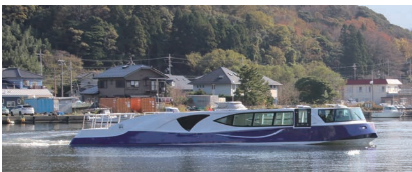
↑久天子湖で実証実験を行う電池推進実証船
