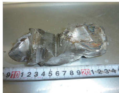
↑破砕機から発見された鉄の塊 (縦5cm、横14cm)
