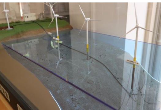
洋上風力には、海底に固定する「着床式」と、海面に浮かべる「浮体式」があるよ。
