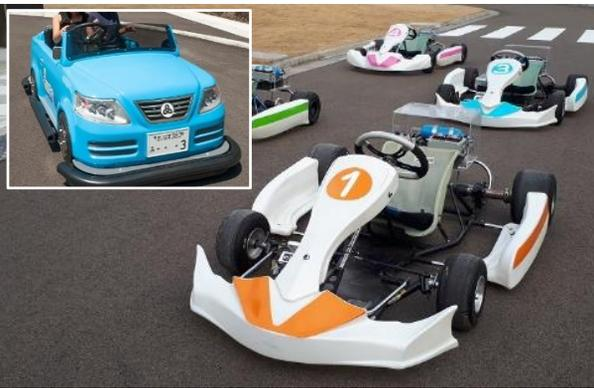
電気で走るバッテリーカー (左上) と水素ポンペを搭載した燃料電池レーシングカー (右)
