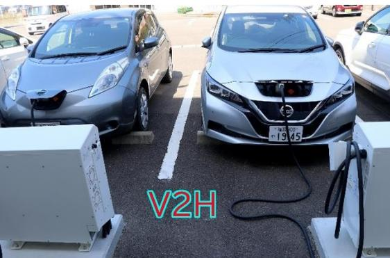
蓄電池容量30/40kWhの電気自動車
