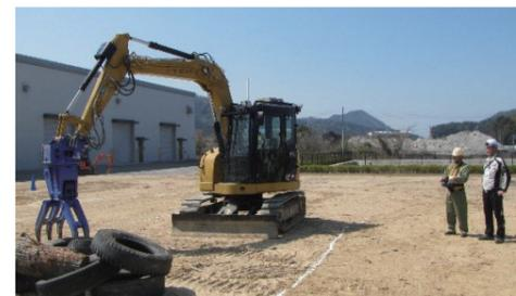
↑無線で操作し、がれきを撤去する重機
