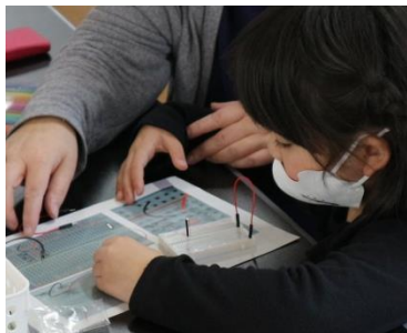
LEDライトをブレッドボード上に配線して、いろいろな色を発光させました。
