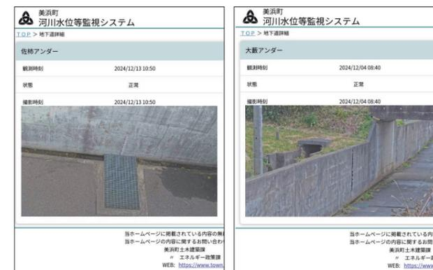
状態表示と撮影写真は10分間隔で更新・公開されています。水位が15cmに達すると一覧の状態表示が「冠水」になり、地図上アイコンにも①が表示されます。現地では、警告のパトランプが点滅します。
